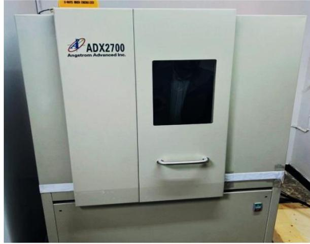
الشكل (13): حيود الأشعة السينية (XRD)
